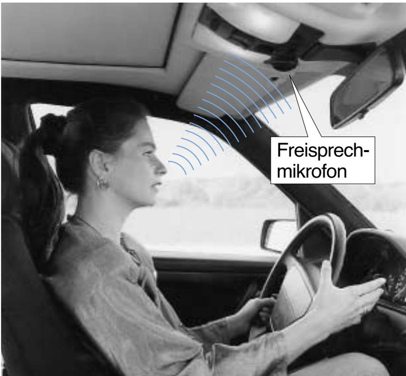
Bild 3: Autotelefon mit Freisprechmöglichkeit
