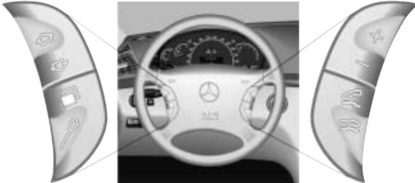
Bild 7: Lenkrad-integrierte Fernbedienung
