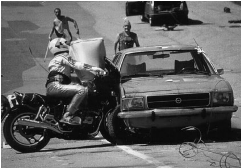
Bild 5: Airbag im realen Crashversuch
