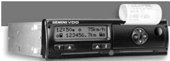
Abbildung: DTCO 1382 von Siemens VDO
