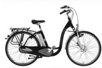
Pedelec mit Mittelmotor
