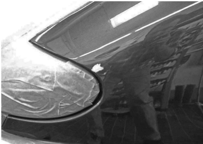
Kotflügel mit kleiner Beschädigung
