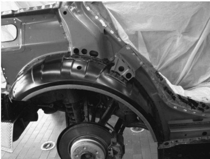
Ersatz des Teiles: Seitenwand herausgetrennt
