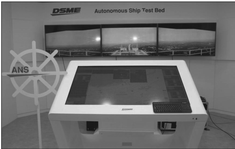
Abb. 8 Prototyp eines von Fraunhofer CML entwickelten autonomen Navigationssystems in Korea
