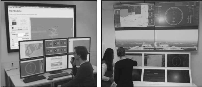
Abb. 11 Prototypen von Landkontrollstationen. Links: Laborversion am Fraunhofer CML, rechts: für Kunden entwickelter Prototyp
